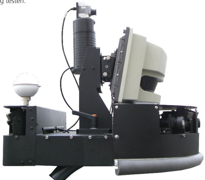
3 Flexibles Sensorsystem des QUANJO TDS
