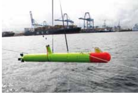
AUV TIETeK kann bis 6000 m tief tauchen.
