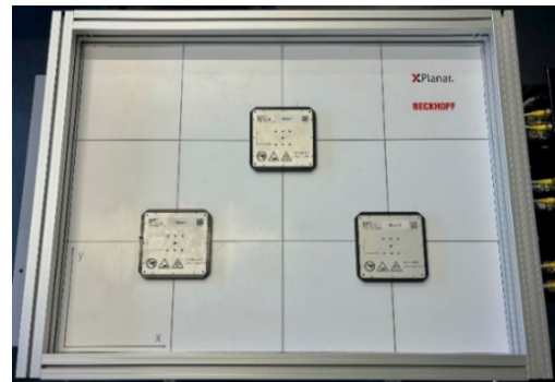
Abb. 2: Das Planarantriebssystem XPlanar.
