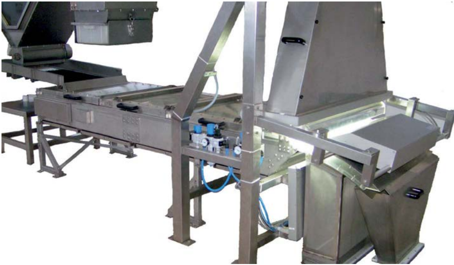
Sortieranlage mit optischer Prüfeinheit, in der eine Zeilenkamera auf das Material schaut.
