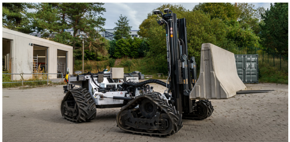
Abb. 1: Der geländegängige Gabelstapler MATS (das Kürzel steht für »Mobiles Autonomes Transportsystem«) dient unter anderem dazu, das autonome Aufnehmen und Abstellen palettierter Lasten sowie deren autonomen Transport im schwierigen Gelände zu trainieren.
