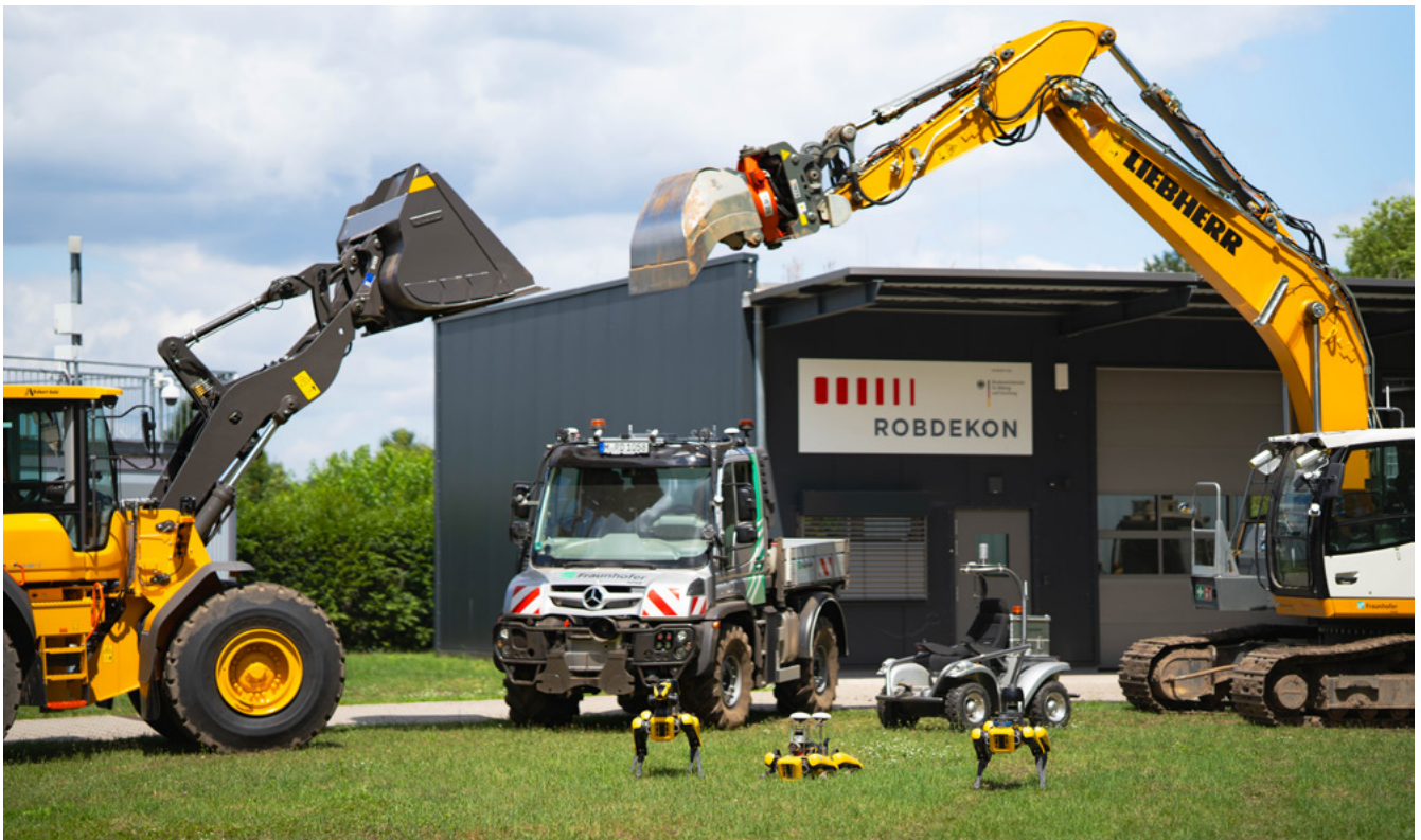
Abb. 2: Die Forschungsflotte autonomer Bau- und Arbeitsmaschinen am Fraunhofer IOSB.
