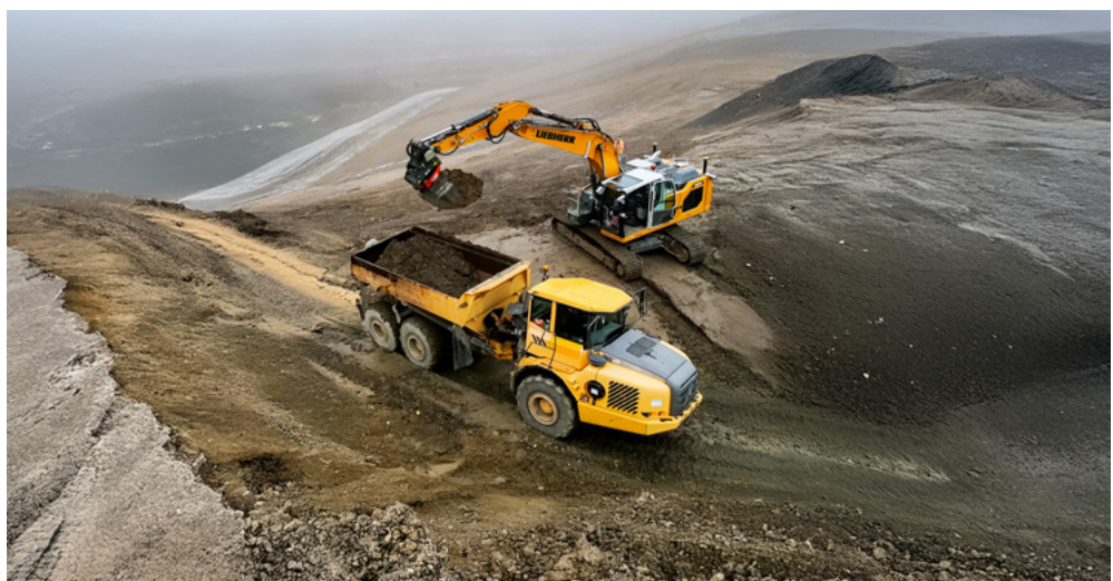
Abb. 1: Der autonome Bagger ALICE hilft beim Sanieren einer Deponie.
