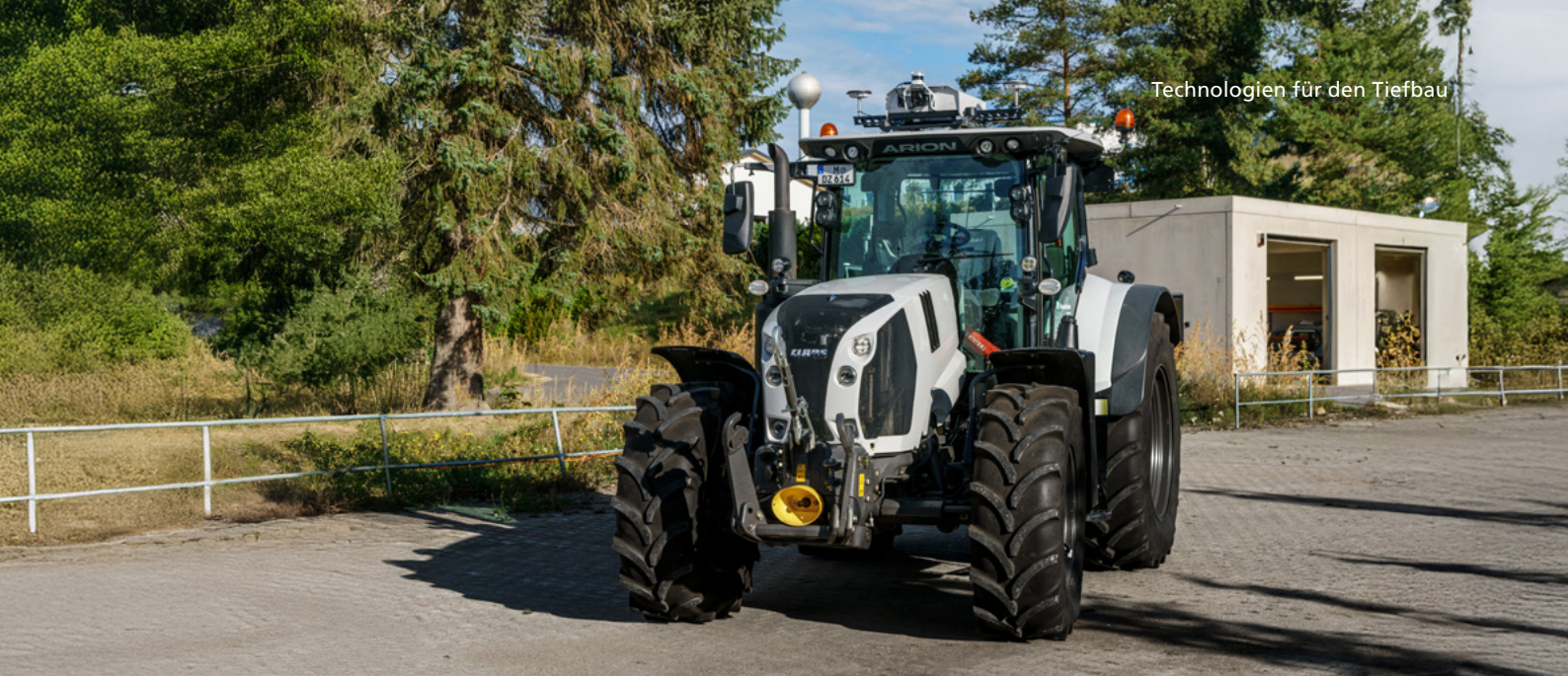
Abb. 2: Der mittels EnvP-Kit umgerüstete Traktor Claas Arion am Fraunhofer IOSB-AST in Ilmenau ist durch seine Vielzahl von Anbaugeräteoptionen breit als autonome Baumaschine einsetzbar – in Verbindung mit einem Anhänger etwa als autonome Transportplattform. Das stellte er in den Projekten AKIT und ROBDEKON erfolgreich unter Beweis.
