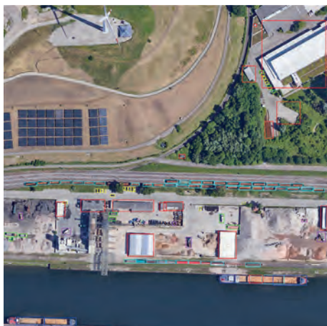
Abbildung 2: Detektion und Klassifikation von Objekttypen mit Deep-Learning-Verfahren in Luftbildern. Legende: Gebäude, Personenfahrzeug, LKW, Flugzeug, Schiff, Baustellenfahrzeug, Eisenbahn
