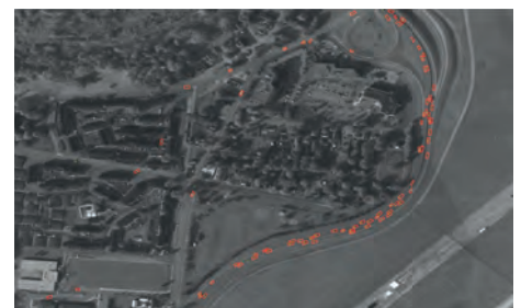
Abbildung 5: In WAMI-Bildfolge detektierte und getrackte Fahrzeuge.
