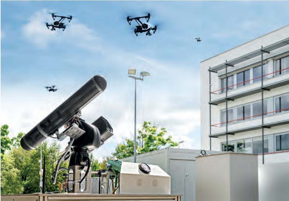
Setzt auf maschinelles Lernen in der Echtzeitauswertung von Kamerabildern: das am Fraunhofer IOSB entwickelte modulare Drohnen-Erfassungs- und Assistenzsystem MODEAS.
