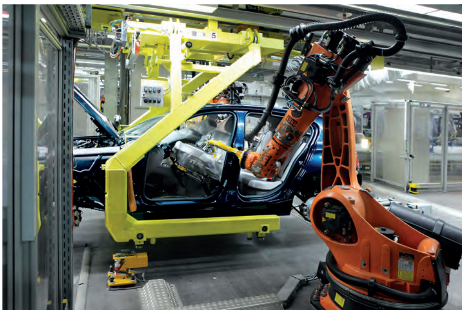
Abb 1: Sitzmontage im BMW-Werk Regensburg. Bildquelle: Presseportal BMW Group Produktion.
