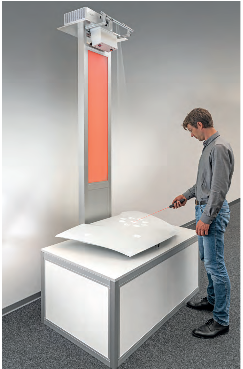
QSelect erfasst per Kamera, wo der Anwender mit dem Laserpointer einen Fehler markiert.
