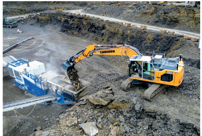
Abbildung 30: Autonomer Bagger des Fraunhofer IOSB beim Beladen eines Brechers
