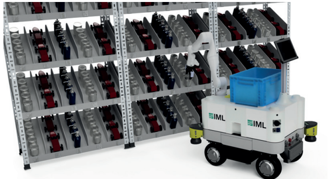
Abbildung 33: Mobiler Manipulatoren-Prototyp des Fraunhofer IML: mögliche Plattform für den Kommissionierungs-Agenten
