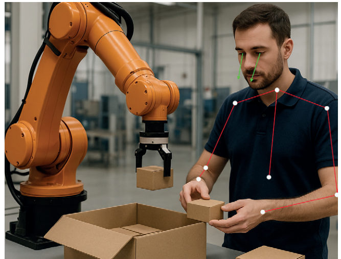
Abbildung 32: Pose und Blickrichtung des Menschen wird erkannt während der Kollaboration mit einem Roboter.
