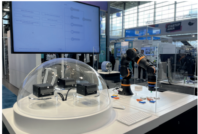
Abbildung 31: Fraunhofer IAIS Demonstrator – ein per Sprache programmierbarer Roboterarm
