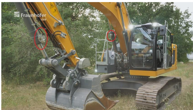
Abbildung 1: Autonome Bagger mit Hydraulikdrucksensoren und geschätzte Kraft am Endeffektor
