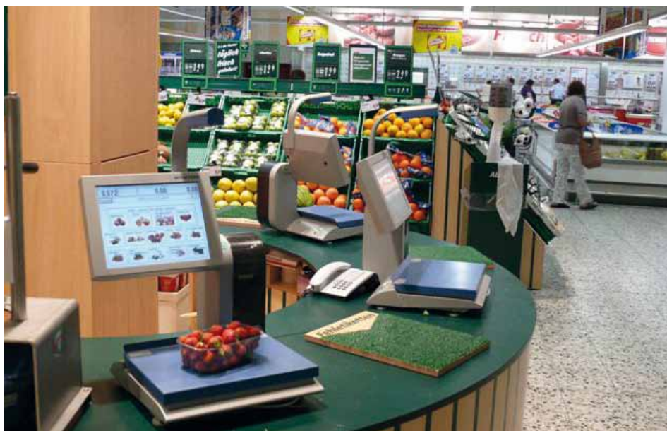
Die »intelligente« Gemüsewaage erkennt per Bildauswertung automatisch die Art der Ware.
