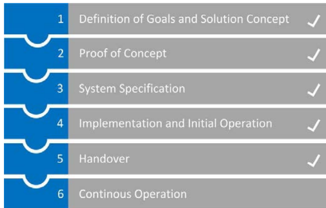
Abb. 1 ML4P-Vorgehensmodell für die Implementierung von Machine-Learning-Methoden in der industriellen Produktion.
