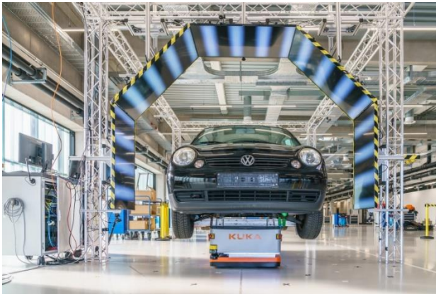
Abb. 1 Im AutoInspect-Demonstrator fährt die Karosserie auf einem Transportsystem zu den Prüfstationen. Das Bild zeigt das Deflektometrie-Portal: Anhand der Spiegelung der auf den Monitoren dargestellten Streifenmuster kann die Software Oberflächendefekte ermitteln.
