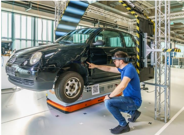
Abb. 2 Auch die manuelle Prüfung ist in den AutoInspect-Workflow integriert. Über die AR-Brille werden Informationen, Prüfaufgaben sowie virtuelle Bedienelemente eingeblendet und die Hand- und Fingerbewegungen des Nutzers detektiert. Der Werker markiert Fehler per Zeigegeste direkt am Bauteil.
