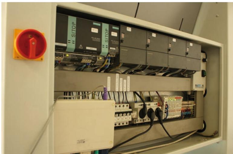
*Die Rückwand des Prototyps: Dort befinden sich die Anschlüsse für die Stromversorgung der LED-Lichteinheit, der Kamertechnik und des Hochleistungsrechners, der die Bohnen in Sekundenbruchteilen prüft. Bei der endgültigen Version des Sortierers werden die Anschlüsse in einem separaten Schaltschrank untergebracht.*
